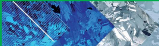
Unter Photovoltaik versteht man die direkte Umwandlung von Sonnenlicht in elektrische Energie. Albert Einstein hat für die Erklärung dieses photoelektrischen Effekts bereits den Nobelpreis erhalten. Die Umwandlung des Sonnenlichts in elektrischen Strom übernehmen Solarzellen, die in Photovoltaikmodulen normalerweise in Reihe geschaltet sind. Die Mehrzahl der im Handel erhältlichen Solarzellen besteht aus dem Halbleitermaterial Silizium.
